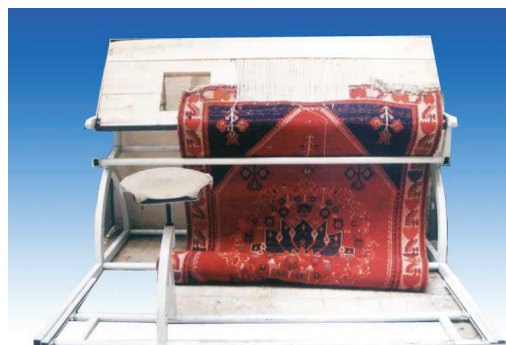
تصویر ۵. اتصال قالی به ایستگاه کاری طراحی شده
