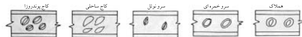
شکل ۲: انواع منغذها در پره‌های چوبی سوزنی برگان (۸)
