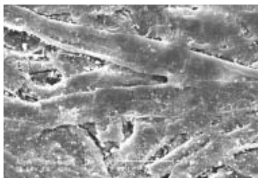
اشکال ۱۲: عکس میکروسکوپ الکترونی SEM الیاف، پرکنده‌ها و پوشاننده‌های کاغذ نقشه قالی کرمان با بزرگ نمایی ۴۰۰X
