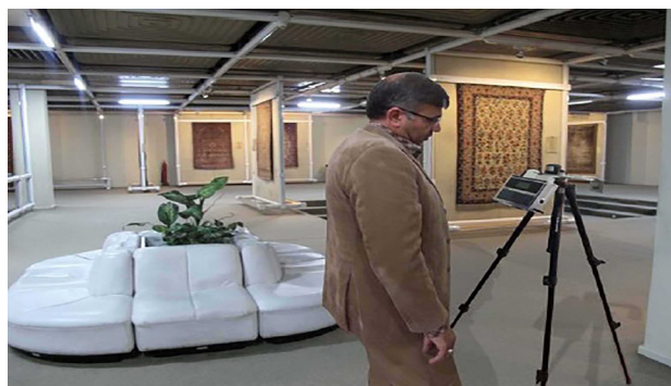
تصویر ۳- دستگاه سنجش آلاینده‌های جوی LSI (نگارنده، ۱۳۹۵)
