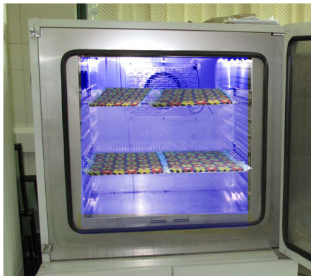
شکل ۱- قراردان نمونه‌ها در دستگاه Binder در شرایط رطوبت، دما و نور جهت پیرسازی (نگارنده، خرداد ۱۳۹۵)
