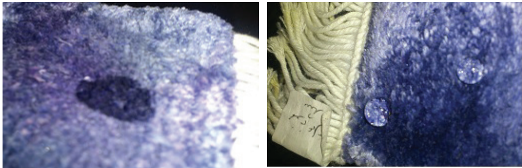
شکل ۳. تصویر قطره روی سطح فرش (شکل سمت راست فرش تکمیل شده با ماده ضدآب و شکل سمت چپ فرش خام) (مأخذ: نگارنده)
