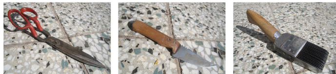
تصویر ۲. سمت راست: شانه گلیم‌بافی و قالیبافی. وسط: چاقوی قالیبافی که در بافتن قسمت‌های قالیبافی در گلیم شیریکی پیچ کاربرد دارد. سمت چپ: قیچی برای بریدن خامه و برش دادن قسمت‌های قالیبافی در روی گلیم. (تصاویر از محله مکی‌آباد واقع در شهر سیرجان. منبع: نگارنده)
