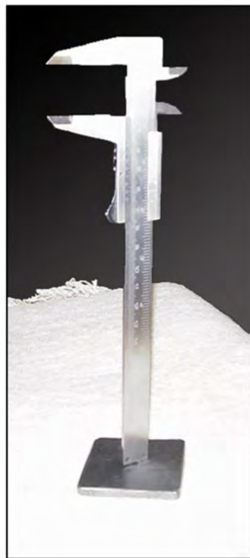
شکل ۲- اندازه‌گیری ارتفاع پرز با استفاده از کولیس و صفحه فلزی
