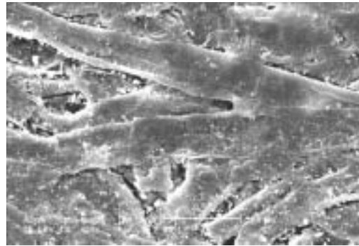
شکل ۱۲: عکس میکروسکوپ الکترونی SEM الیاف، پرکننده‌ها و پوشاننده‌های کاغذ نقشه قالی کرمان با بزرگ‌نمایی ۴۰۰x
