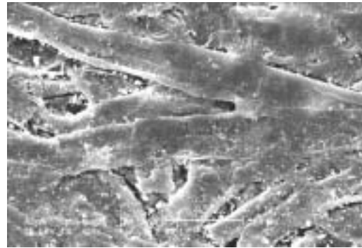
اشکال ۱۲: عکس میکروسکوپ الکترونی SEM الیاف، پرکننده‌ها و پوشاننده‌های کاغذ نقشه قالی کرمان با بزرگ‌نمایی ۴۰۰x
