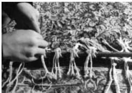
شکل ۲۴: قرار دادن میله فلزی لایه لای شیرازه‌های دوخته شده
