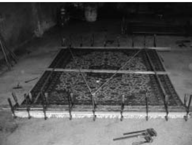
شکل ۱۸: بستن گیره‌ها بصورت ضربدری در دارکشی پرسی سنتی
