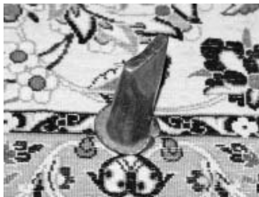
شکل ۶: گوه فلزی مورد استفاده در دستگاه ماشین کش
